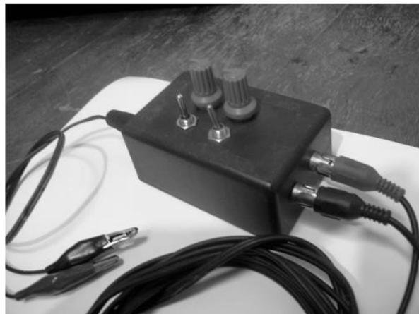
Fig. 23. Interface artesanal para puntas de osciloscopio conectada al computador y al Software Virtual
